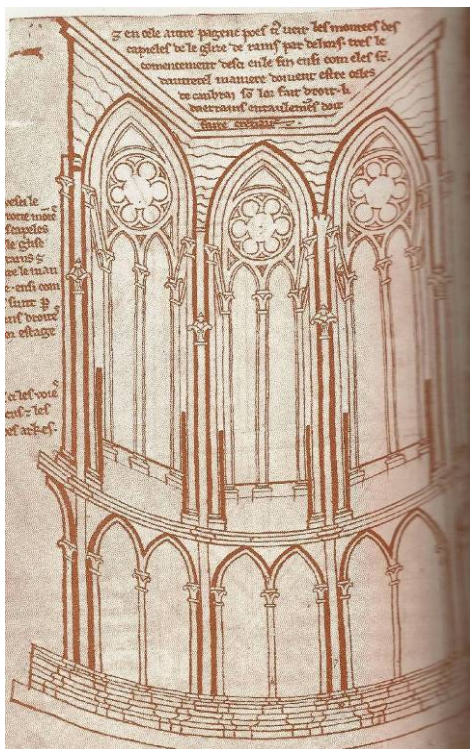
Fig. 4.4. Trazados Geométricos para la composición de vanos y tracerías. Tratado de Villard de Honnecourt
