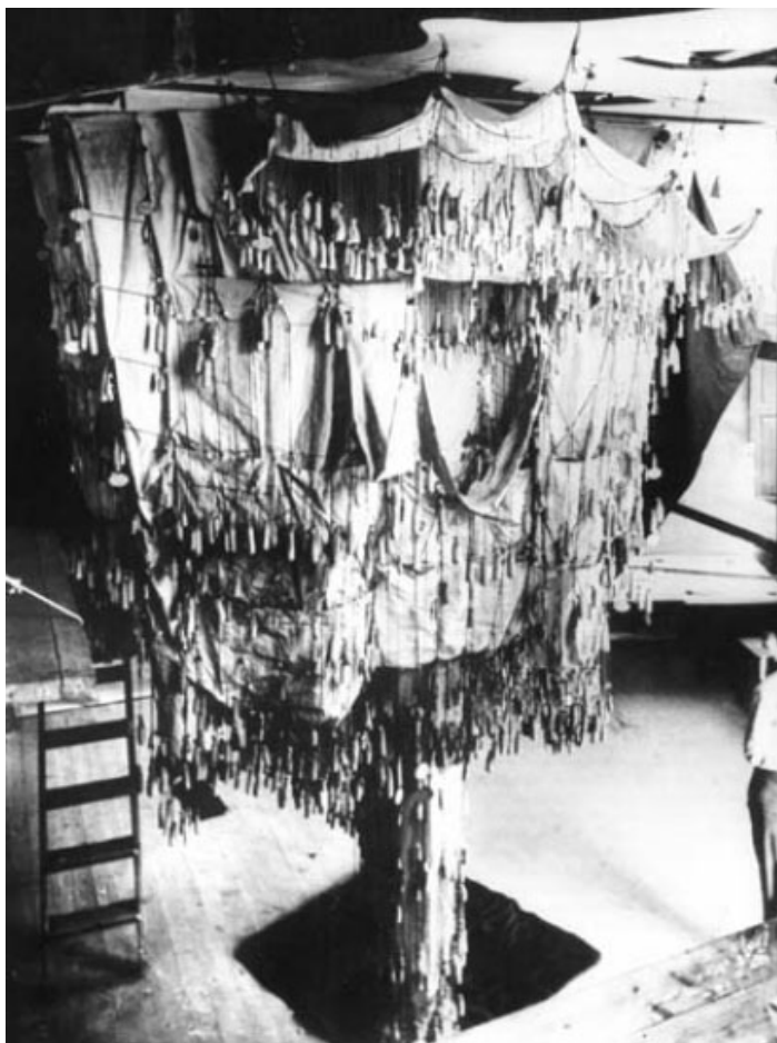
Fig. 5.11. Modelo estructural polifuncular de la iglesia de la Colonia Güell de Antoni Gaudí y Cornet. Fuente: http://commons.wikimedia.org . 113
