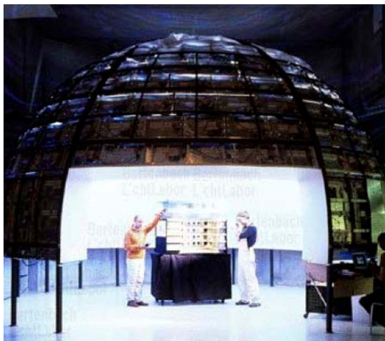
Fig. 5.16. Vista del "cielo artificial" del Laboratorio de Bartenbach. Fuente: http://www.bartenbach.com
