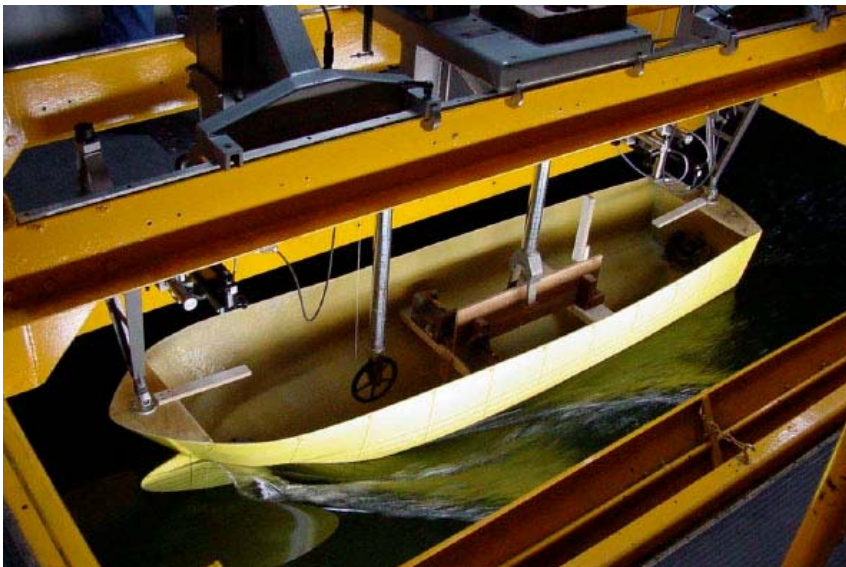
Fig. 5.10. Ensayo de casco de barco en el Canal de Ensayo de la Escuela Técnica Superior de Navales de la UPM. Fuente: http://canal.etsin.upm.es
